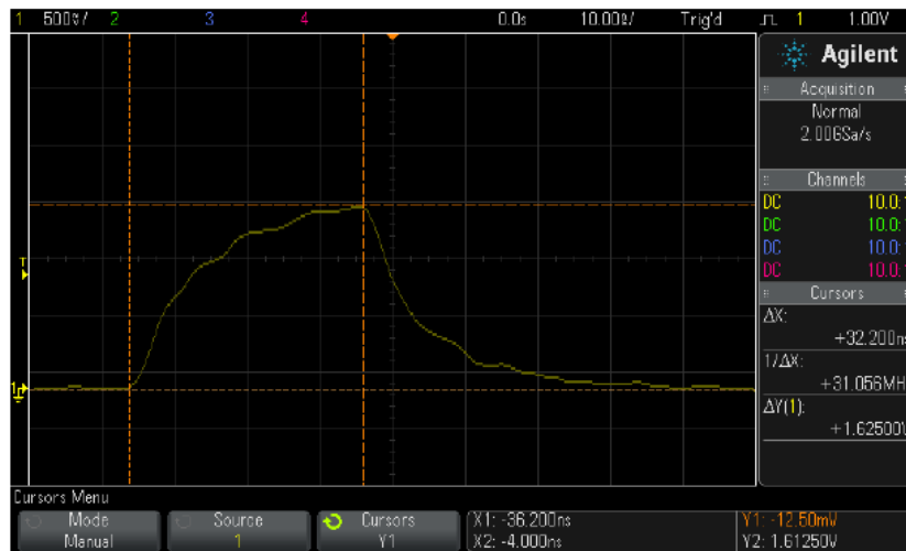
Rys. 21. Pomiar szerokości impulsu – pomiar nie jest wykonywany na wysokości odpowiadającej połowie amplitudy
