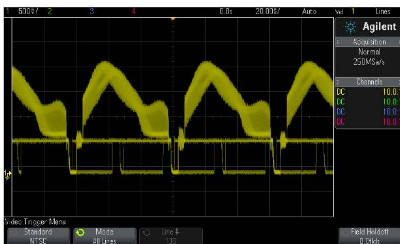
Rys. 12. Przykład wyzwalania wszystkimi impulsami synchronizacji
